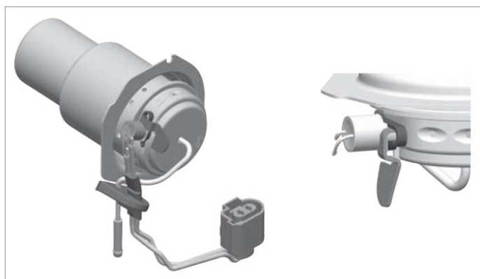
Рис. 9-12 Правильная установка штифта накала
