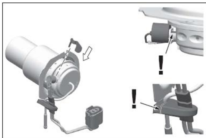
Рис. 9-10 Установка охлаждающего ребра
