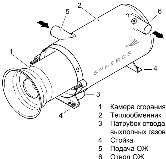
Рис. 807 Демонтаж и установка камеры сгорания
