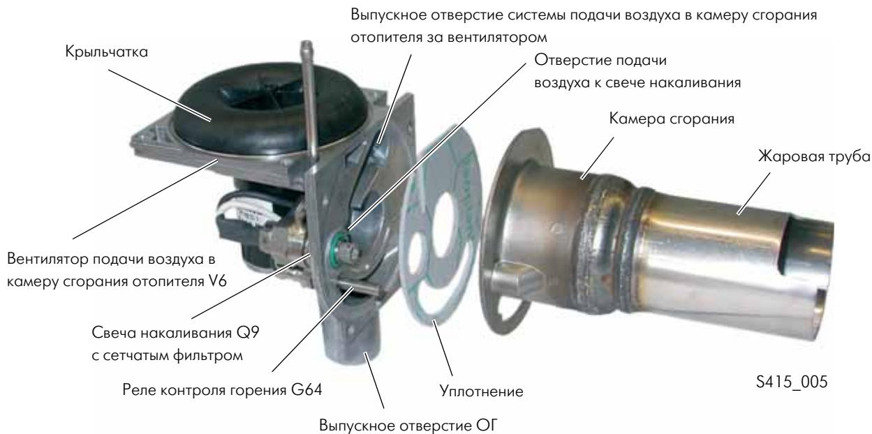
Управление вентилятора подачи воздуха в камеру сгорания отопителя осуществляется блоком управления дополнительного отопителя J364/блок управления 2 дополнительного отопителя J824 в соответствии с необходимой частотой вращения. На него подаётся стабилизирующее напряжение питания, макс. 8,4 В.
