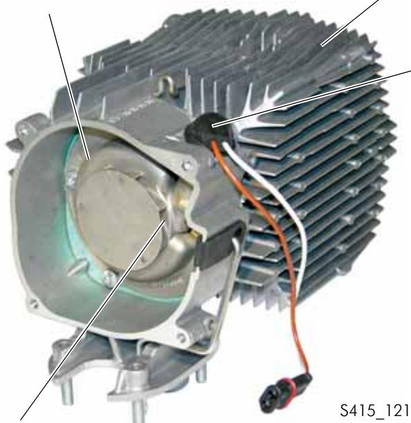
Впускные отверстия подачи воздуха в камеру сгорания отопителя от вентилятора подачи воздуха в камеру сгорания отопителя
