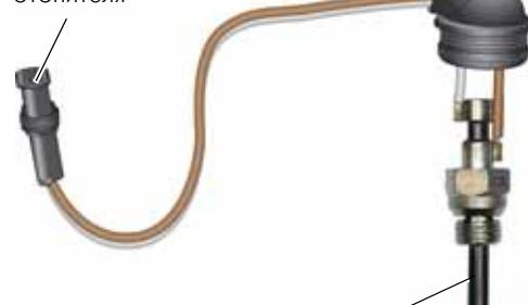
Свеча накаливания отопителя Q9
