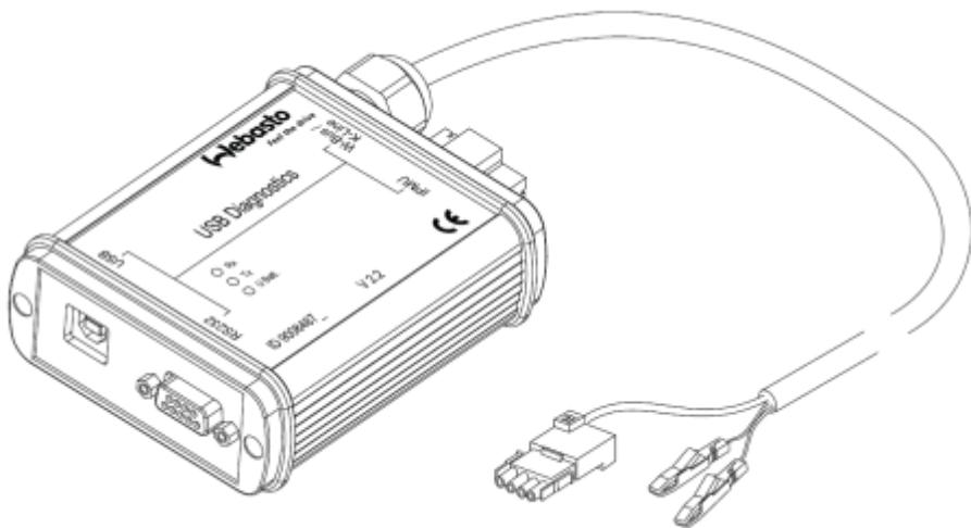
Этот преобразователь подключается между USB-портом компьютера и диагностическим проводом блока управления. Для преобразователя требуется электропитание от бортовой сети автомобиля (12/24В и масса).
