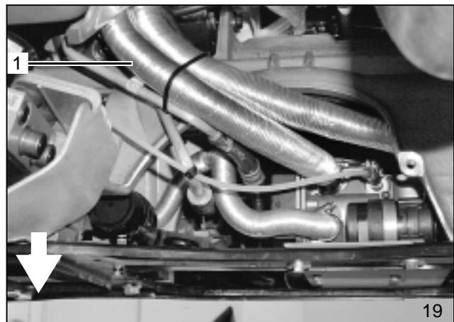
**Wassereinbindung bei Benzinmotor**
