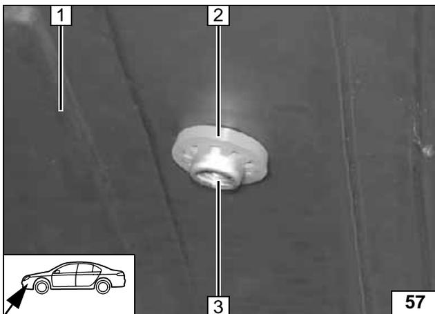
Unterfahrschutz lose montieren, Lage vom Profilgummi übertragen und  $\varnothing$  42mm im Bereich Abgasaustritt bohren!
