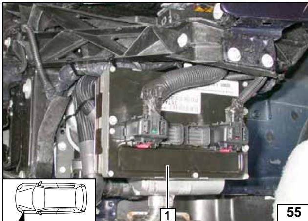
Steuergerät 1 mit fzg.eigene Schrauben an Halterung montieren und mit Stecker komplettieren!
