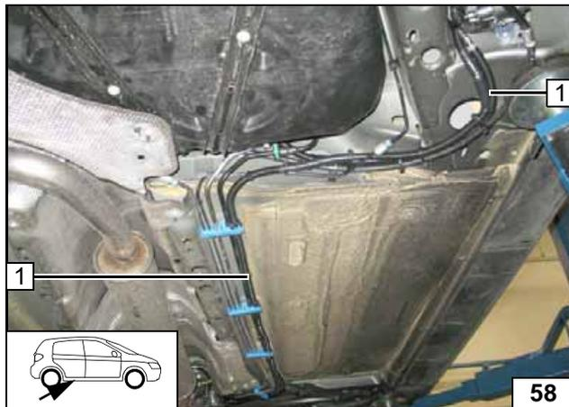
Brennstoffleitung und Kabelbaum Dosierpumpe in Wellrohr Ø 10 1 an fzg.eigenen Kraftstoffleitungen zum Einbauort Dosierpumpe verlegen!
