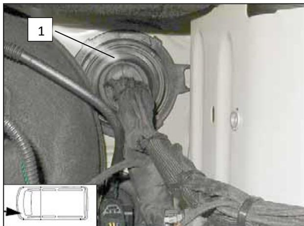
Снять накладку **1**.
