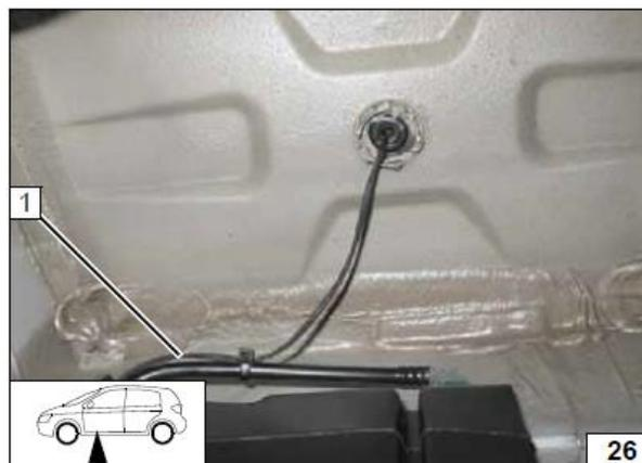
Осуществить подключение вблизи 6-контактного разъёма 2 догревателя
