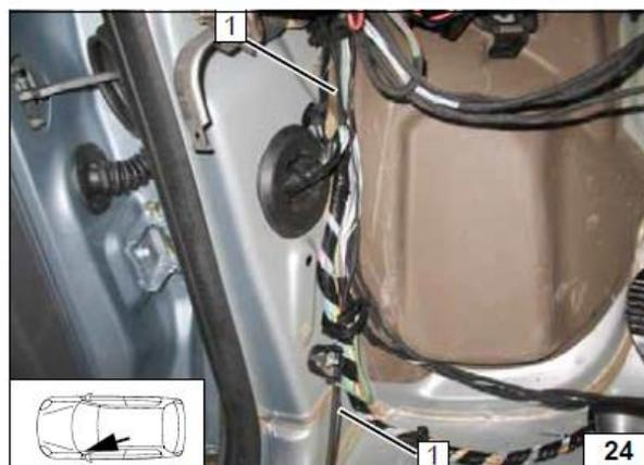
1 – уплотнительная заглушка, отверстие  $\varnothing 17\text{мм}$ , защитное резиновое уплотнение
