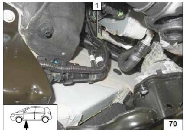
Проложить топливную линию **1** вдоль штатных трубок.
