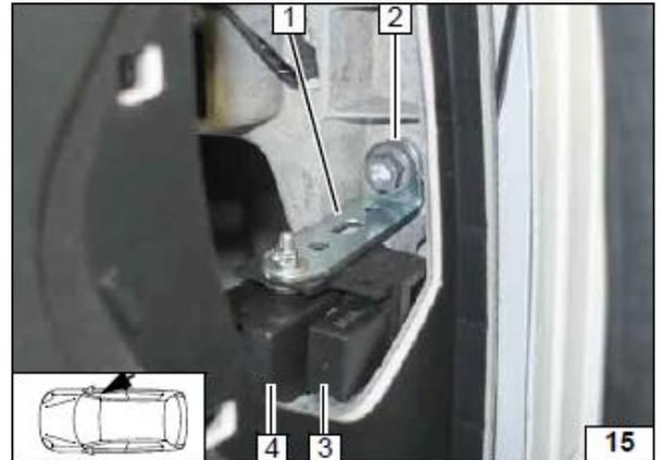
Соединить жгут колодки предохранителей салона 1 и жгут, входящий в салон 2.
