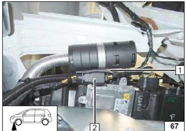
Проложить топливную трубку и жгут **1** вдоль штатных жгутов автомобиля **2** до моторного щита.
