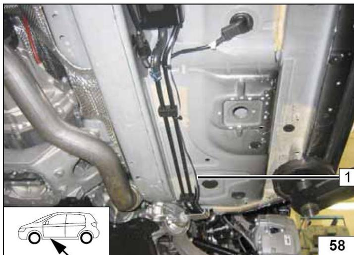
1 Топливопровод и жгут проводов на насос дозатор
