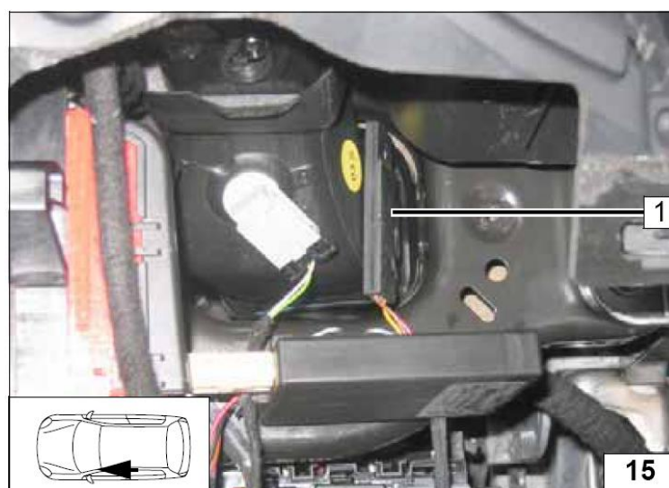
Расположение температурного датчика 1 (только для Телестарт НТМ 100)
