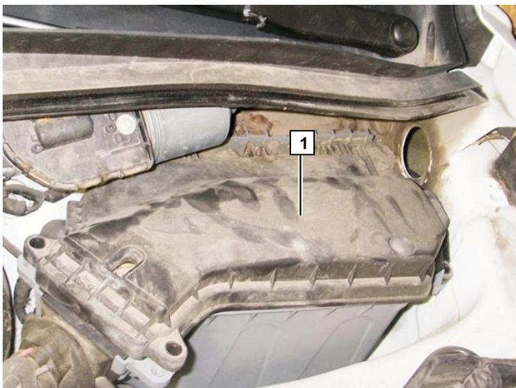
Извлечь электронный модуль из гнезда 1.
