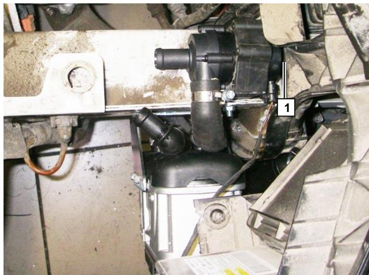
**1** шланг А (от двигателя к циркуляционному насосу)
