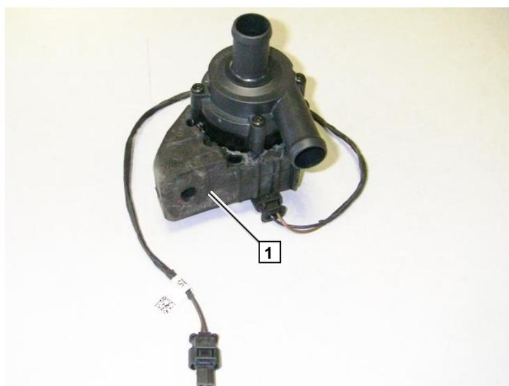
Установить циркуляционный насос и подключить в жидкостной контур
