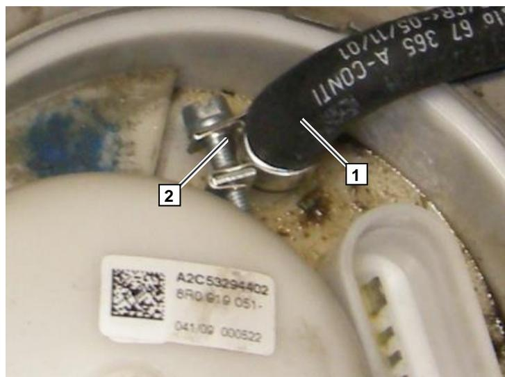
1 Топливозаборную трубку укоротить до
