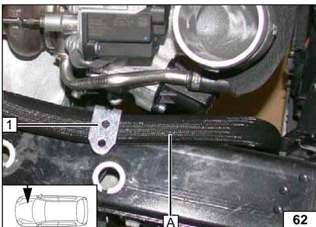
Schlauch **A** unter vormontierten Lochband 1 verlegen!
