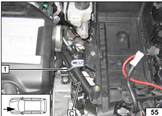
Schlauch C durch gummierte Rohrschelle 1 verlegen!
