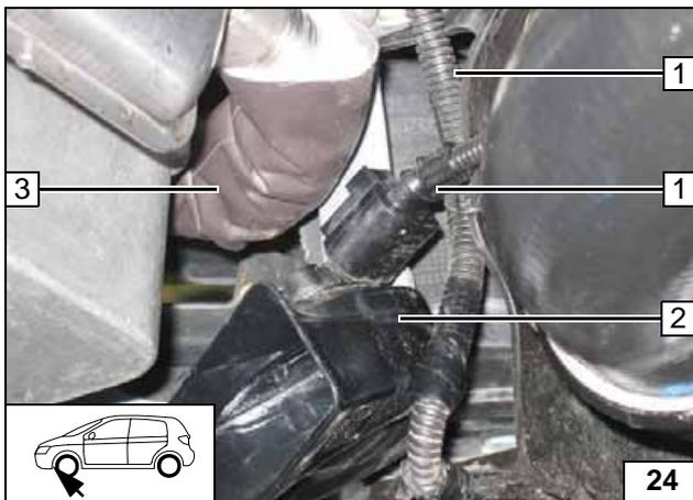
Auf Freigängigkeit der Abgasanlage zu fzg.eigenen Bauteilen und Leitungen achten!
