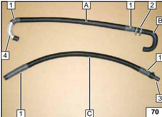
Flechtschutzschläuche auf Schlauch A und C aufschieben und ablängen.
