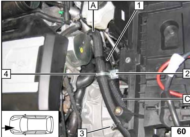
Schlauch **A** an Clipkabelbinder **3** befestigen!!
