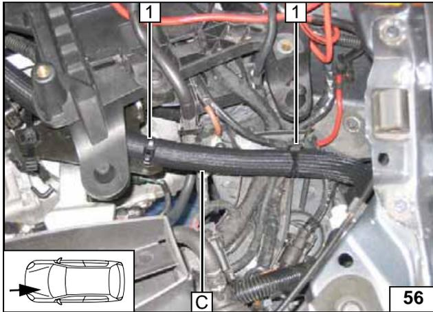
Schlauch C an Clipkabelbinder 1 [2x] befestigen!!
