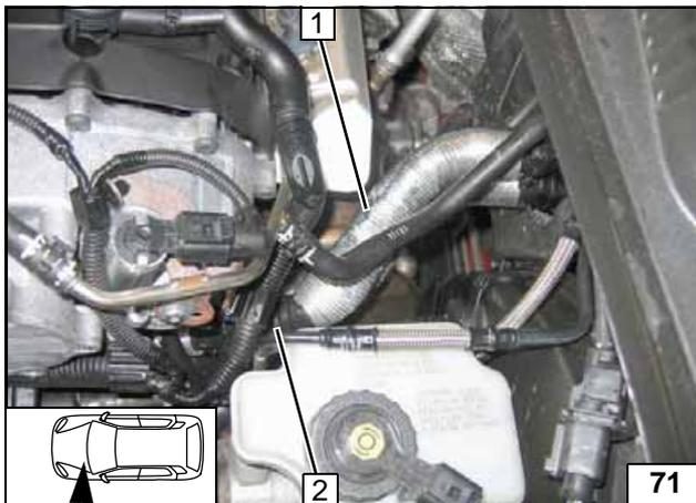
Schlauch Motorausgang zum Wärmetauschereingang 1 am Stutzen Motorausgang abziehen! Federbandschelle 2 wird wieder verwendet!
