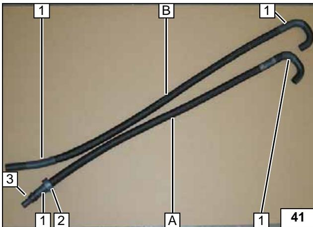
Flechtschutzschläuche auf Schlauch A und B aufschieben, ablängen und einschrumpfen!
