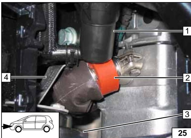
Auf Freigängigkeit der Abgasanlage zu fzg.eigenen Bauteilen und Leitungen achten! Profilgummi 2 positionieren!
