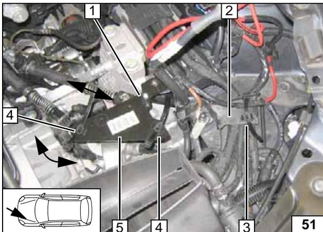
Bohrung Ø 6 in Abdeckung Kabelkanal 2 an Position 3. Beim Bohren auf dahinterliegende Leitungen achten!
