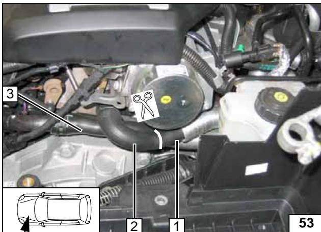
Schlauch Motorausgang / Wärmetauschereingang an der Markierung trennen!
