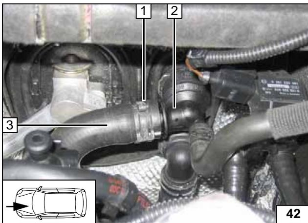
Schlauch Motorausgang zum Wärmetauschereingang 3 am Stutzen Wärmetauschereingang 2 abziehen! Federbandschelle 1 wird wieder verwendet!
