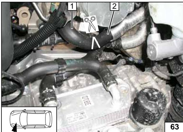
Schlauch Motorausgang / Wärmetauscher-
