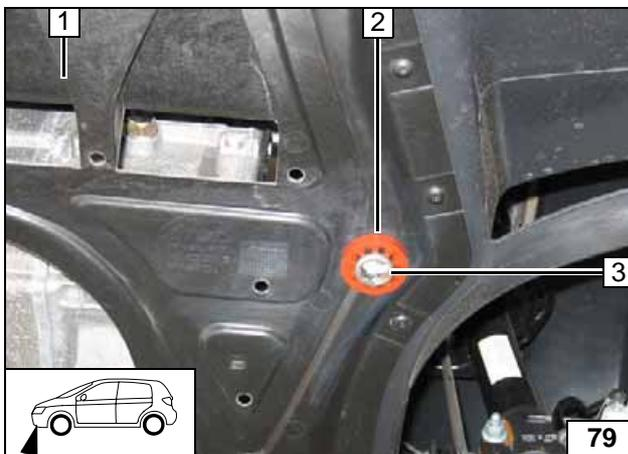
Abgasendstück **3** bündig am Profilgummi rot **2** ausrichten!
