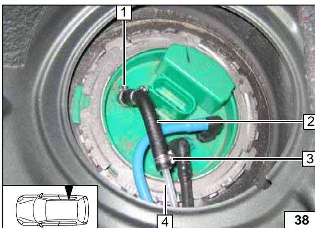
Sollte das Steigrohr im Anlieferungszustand leicht gekrümmt sein, dann ist so auszurichten, daß das Ende nach hinten, rechts zeigt! Sonst besteht die Gefahr, daß die Füllstands-
