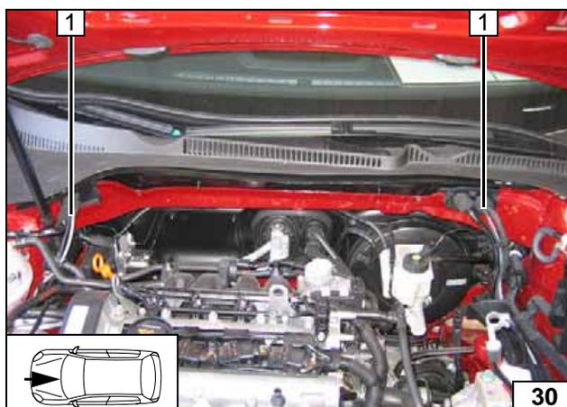
Brennstoffleitung und Kabelbaum Dosierpumpe 1 im Wasserkasten an fzg.eigenen Leitungen mit Kabelbindern befestigen! Besonders auf Freigängigkeit des Wischergestänges achten!
