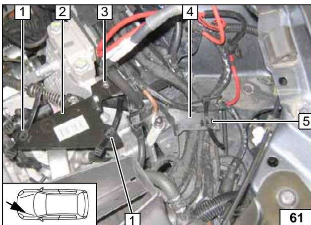
Bohrung Ø 6 in Abdeckung Kabelkanal **4** an Position **5**. Beim Bohren auf dahinterliegende Leitungen achten!
