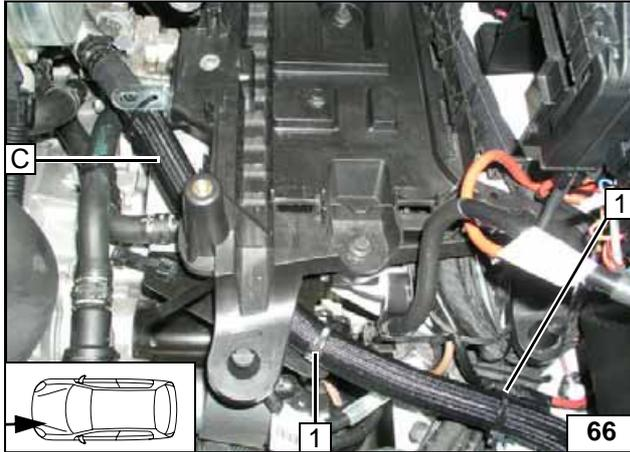
Schlauch **C** an Position **1** mit vormontierten Clipkabelbindern [2x] befestigen!
