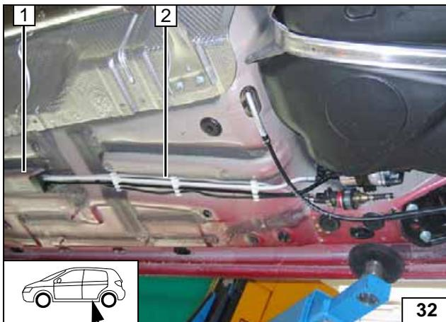
Brennstoffleitung und Kabelbaum Dosierpumpe entlang der fzg.eigenen Kraftstoffleitungen **2** zum Tank verlegen!
