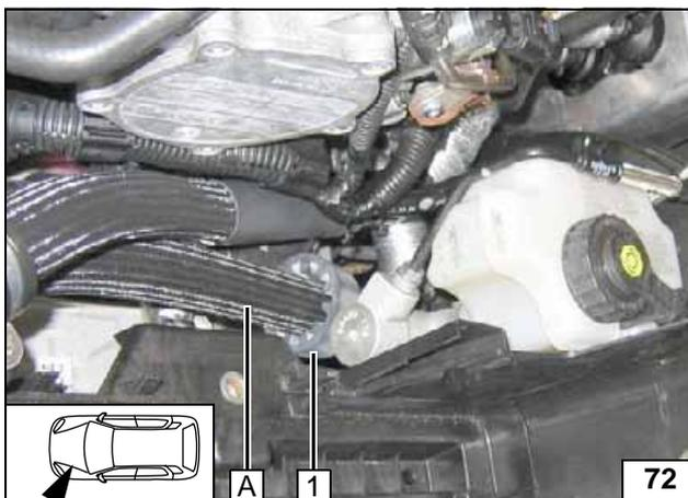
Schlauch A mit 180°-Bogen am Stutzen Motorausgang anschließen!
