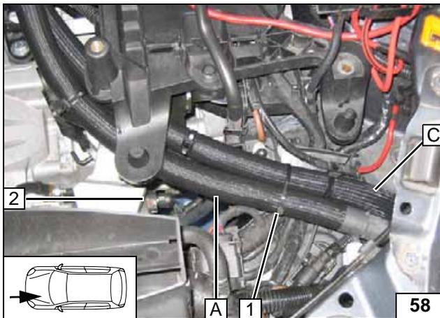
Schlauch A entlang Schlauch C verlegen!
