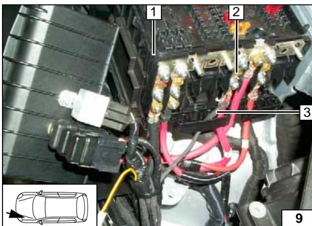
Masseleitung br zu fzg.eigenem Massestützpunkt unterhalb des Scheinwerfers verlegen und anschließen!
