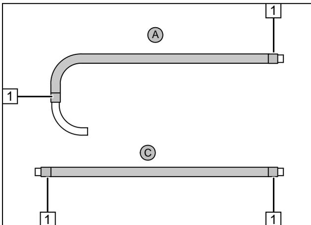
Flechtschutzschläuche auf Schlauch A und C aufschieben und ablängen. Schrumpfschlauch zuschneiden.
