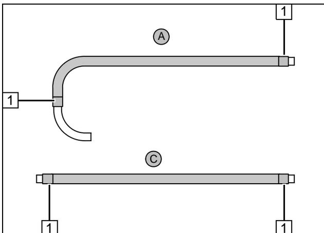
Flechtschutzschläuche auf Schlauch **A** und **C** aufschieben und ablängen.
