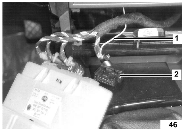
**Bedienungs- und Anzeigeeinheit mit 3 Steckern**
