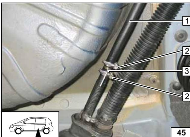
Tankentnehmer 3 in Tankbelüftungsleitung 1 einsetzen!
