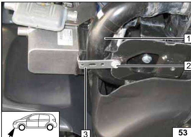
Lochband 3 mit fahrzeugeigener Schraube 2 von Halterung Ladeluftrohr 1 montieren!
