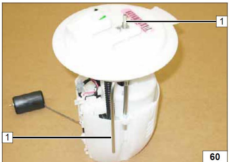
Установить топливный насос в соответствии с инструкцией производителя.
