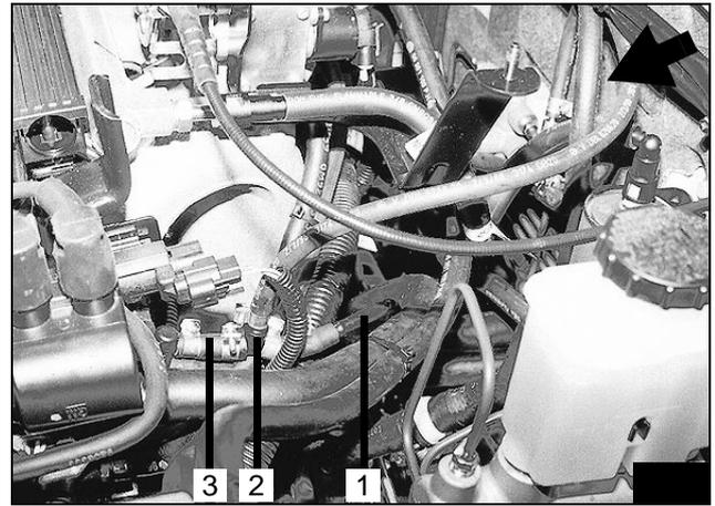
**Einbindung in den Wasserkreislauf**
