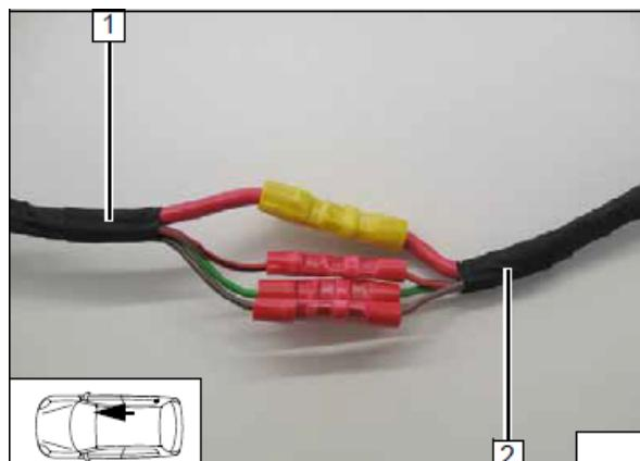
Подключение осуществляется возле 2-конт. разъёма D-113 вентилятора (**2**).
