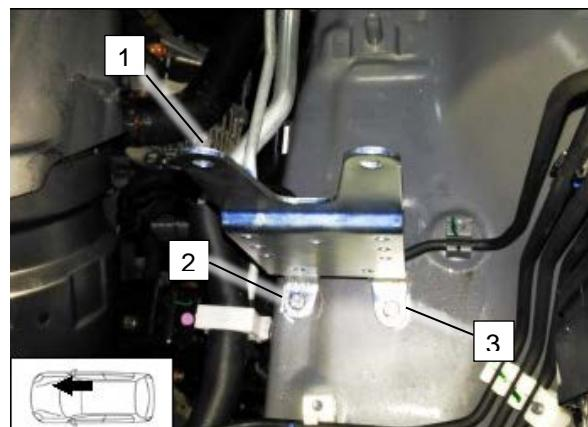
Закрепить подогреватель на кронштейне с помощью винтов 5x13 (**1**)
