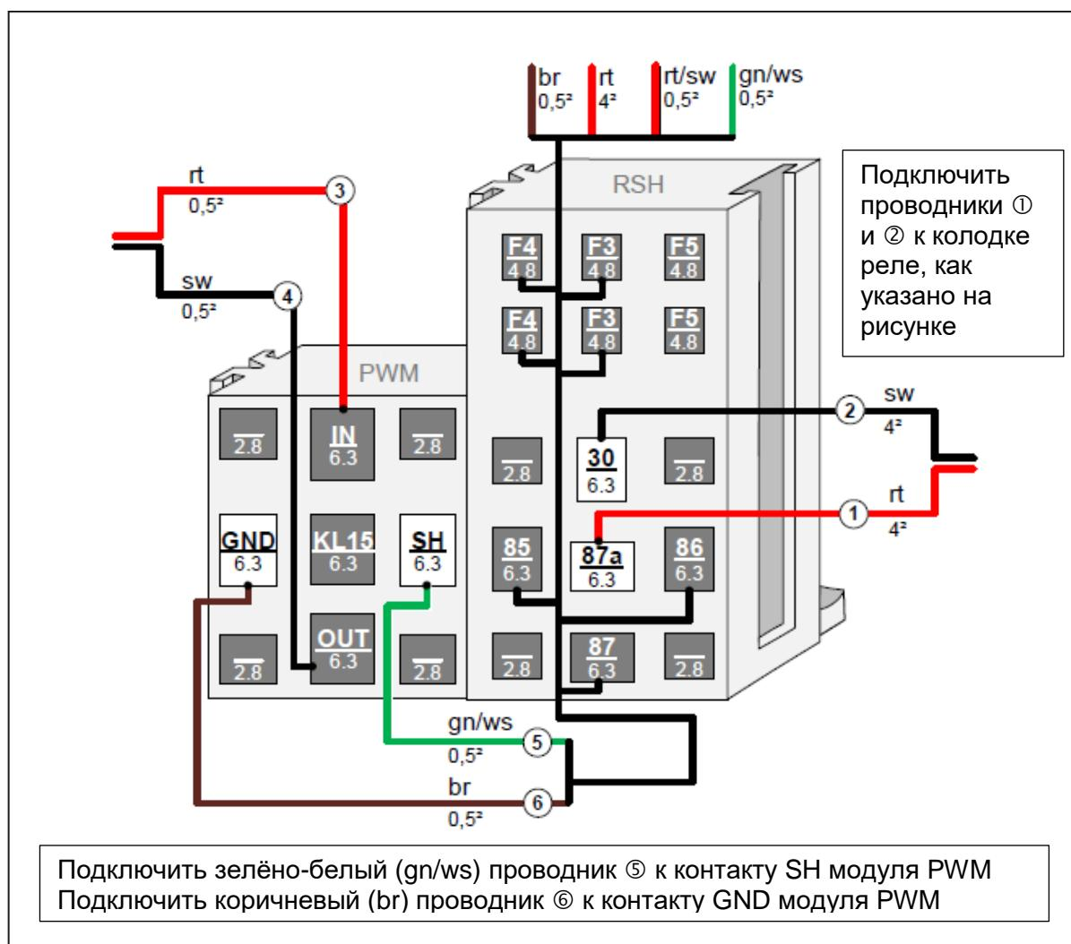
Подготовить салонную колодку предохранителей и реле.
