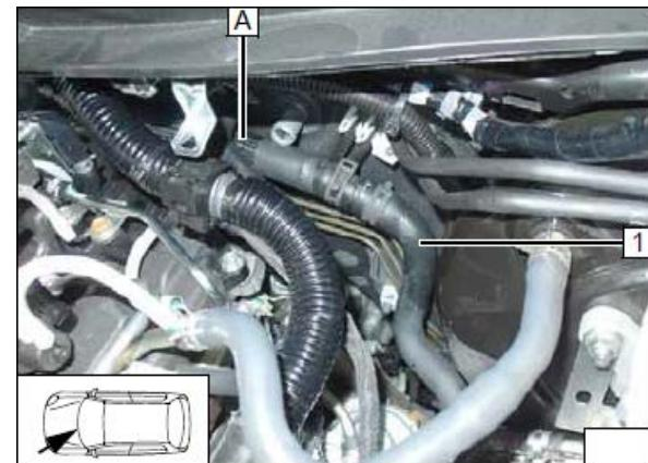
Подключить шланг **E** на выход подогревателя, зафиксировать хомутом &25. Проложить шланг вдоль шланга **A** до точки подключения. Следить за достаточным расстоянием до выхлопной системы автомобиля, подвижных элементов двигателя.
