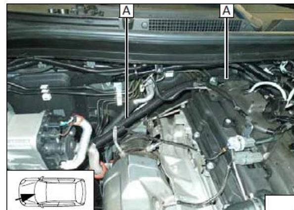
Подключить шланг **A** к шлангу **1**, выходящему с двигателя автомобиля, с помощью прямого штуцера &18x18, хомутов &25.
