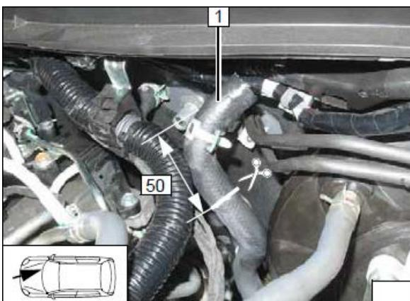
Закрепить угловой кронштейн **1** для фиксации жидкостного насоса.
