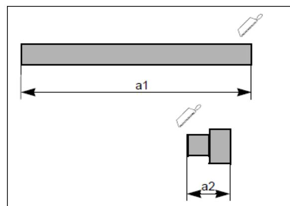
Закрепить часть трубы **a1** на подогревателе (силовым хомутом) и спустить её вдоль выхлопной системы. При необходимости использовать дистанционное кольцо **1**.
