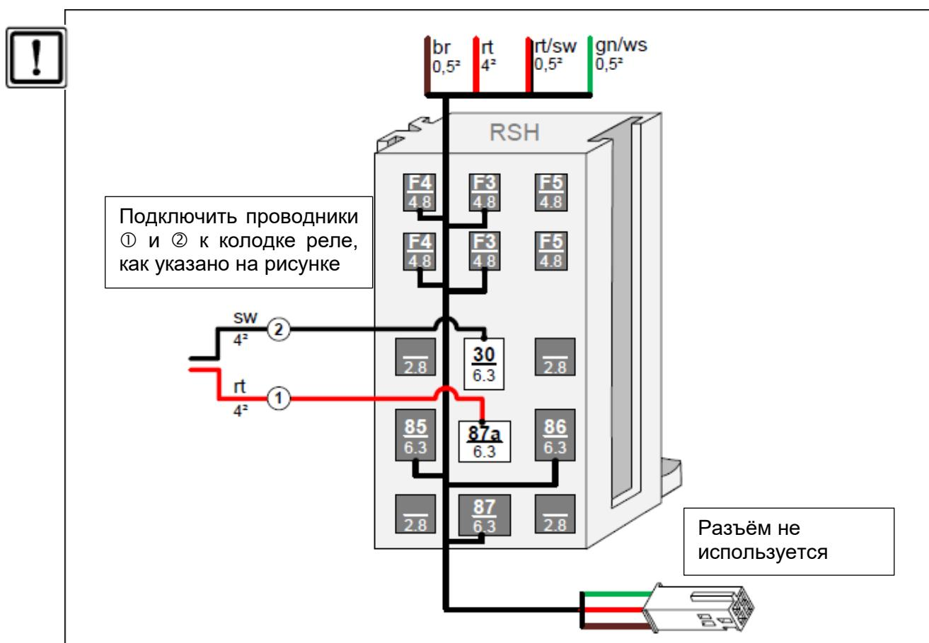
Подготовить салонную колодку предохранителей и реле.
