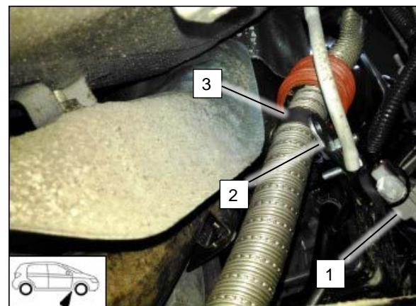
Закрепить трубку на кузове с помощью хомута **1**.
