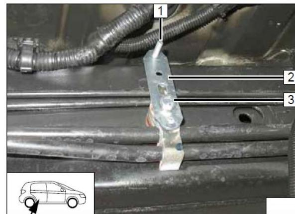
Подготовить топливный насос-дозатор **1**, смонтировав его в суппорте **3**. Закрепить суппорт на кронштейне, используя установленный болт M6x25 **2**.
