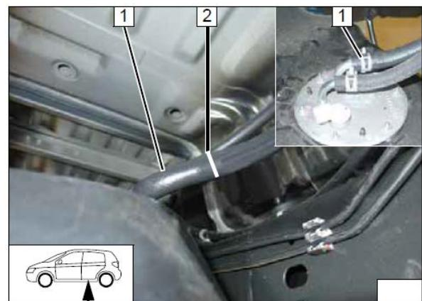
Разрезать шланг **1** в точке **3**. Установить тройник 12x5x12 **6**, используя хомуты 16-27 мм **2**. Подключить топливную трубку от насоса-дозатора **4** к тройнику **6**, используя резиновый шланг **5**.
