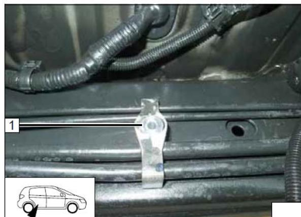
Подготовить пластину крепления насоса. Рассверлить отверстие **1** сверлом диаметром 8,5 мм.
