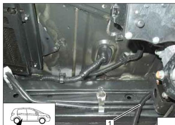
Подготовить место для крепления кронштейна насоса-дозатора. Удалить штатный болт **1**.
