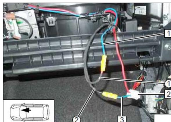
Подключение PWM модуля осуществляется к розовому (pk) проводу **1** (контакт 13) 32-контактного разъёма D-106 **2** панели управления климатом.
