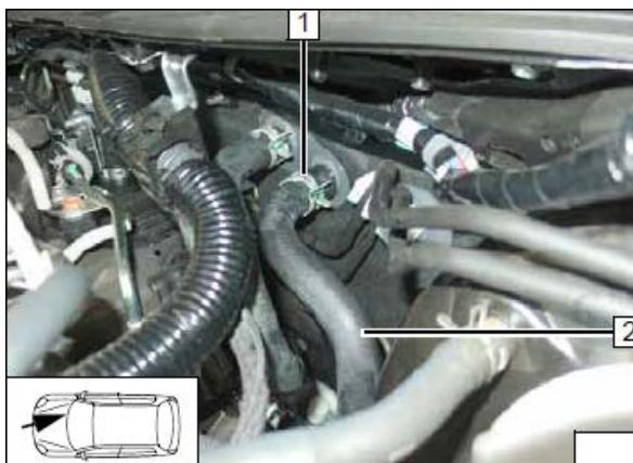
Разрезать шланг **1** на достаточном для подключения расстоянии.
