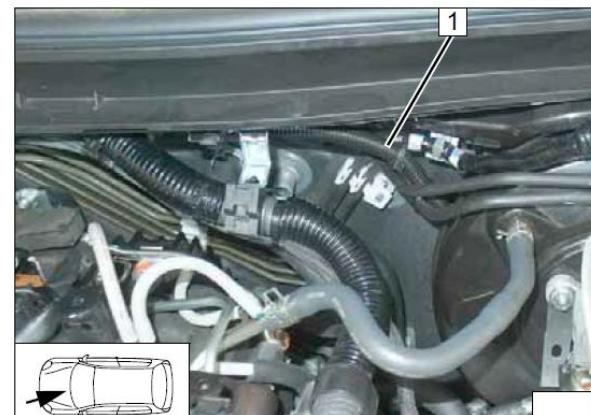
Проложить магистраль **1** вдоль штатных топливных трубок автомобиля до места установки насоса-дозатора.
