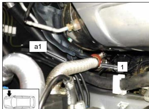
Перенести штатный разъём **1** (фиксация пластиковым хомутом). Использовать отверстие крепление разъёма для фиксации пластины **2**.
