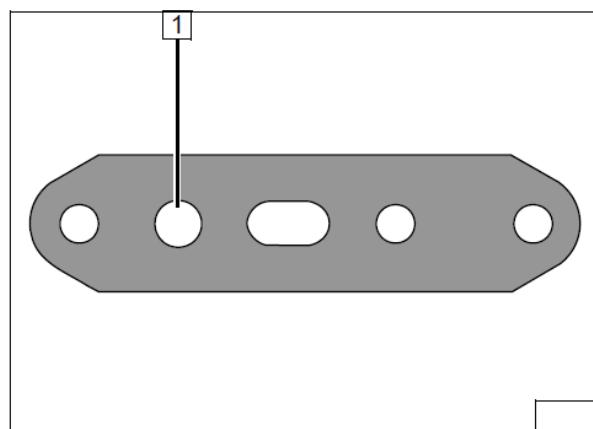
Зафиксировать подготовленную пластину **2** болтом M8x40 **3**. Установить на кронштейн болт M6x25 **1**.
