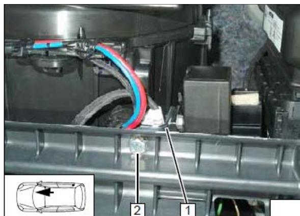
Соединить жгут, введённый в салон, **1** и жгут колодки предохранителей и реле салона **2**.
