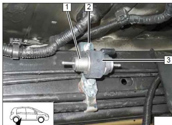
Подключить разъем проводки насоса-дозатора **1**. На выход насоса-дозатора подсоединить топливную магистраль до подогревателя **3**, используя резиновую трубку **2**. Зафиксировать топливопровод хомутом-стяжкой **4**.
