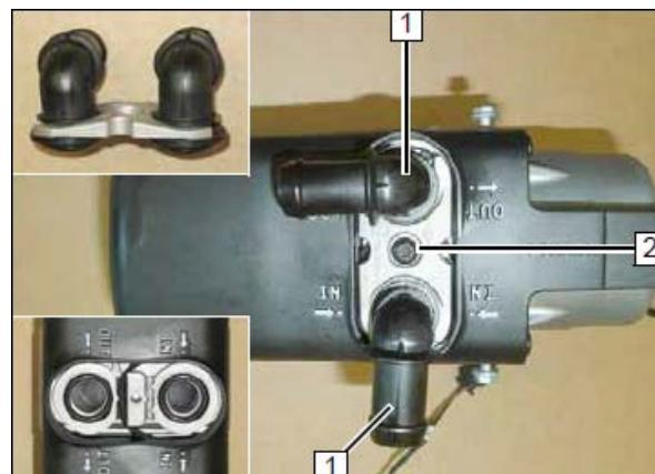
Подготовить резьбу в отверстиях для крепления с помощью самонарезных винтов 5x13 (1).
