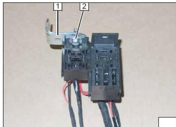
Установить PWM-модуль **1**, 5-контактное реле **2**, предохранитель F4 25A **3**.
