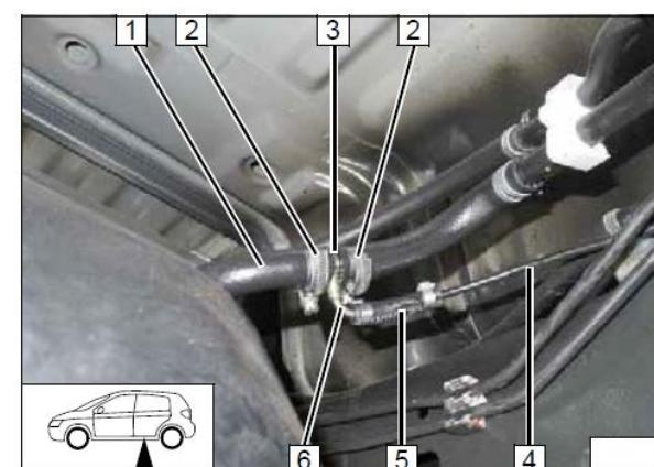
Подсоединить топливную трубку от топливозаборника 3 на вход насоса-дозатора, используя шланг 1. Зафиксировать топливопровод хомутами-стяжками 2.
