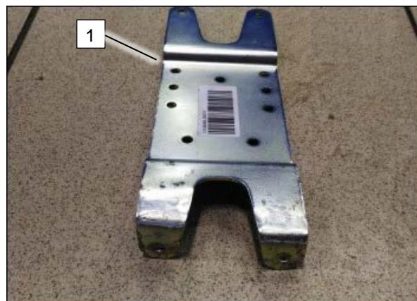
Разметить с помощью кронштейна и посверлить два отверстия.
