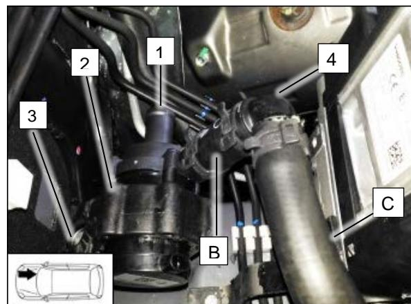
Подключить шланг **C** на вход подогревателя с помощью углового патрубка и отрезка шланга **D**.
