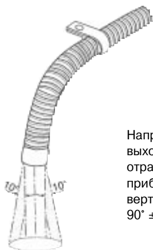
Рис. 809 Конец трубы отвода отработавших газов, положение при монтаже
